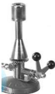
Мультигазовая лабораторная горелка Бунзена с откидным клапаном фирмы Bochem
