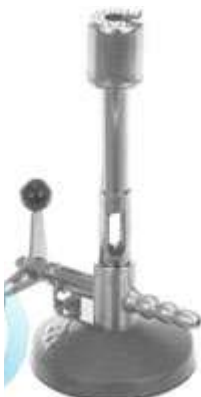
Газовая лабораторная горелка Бунзена с откидным клапаном фирмы Bochem
